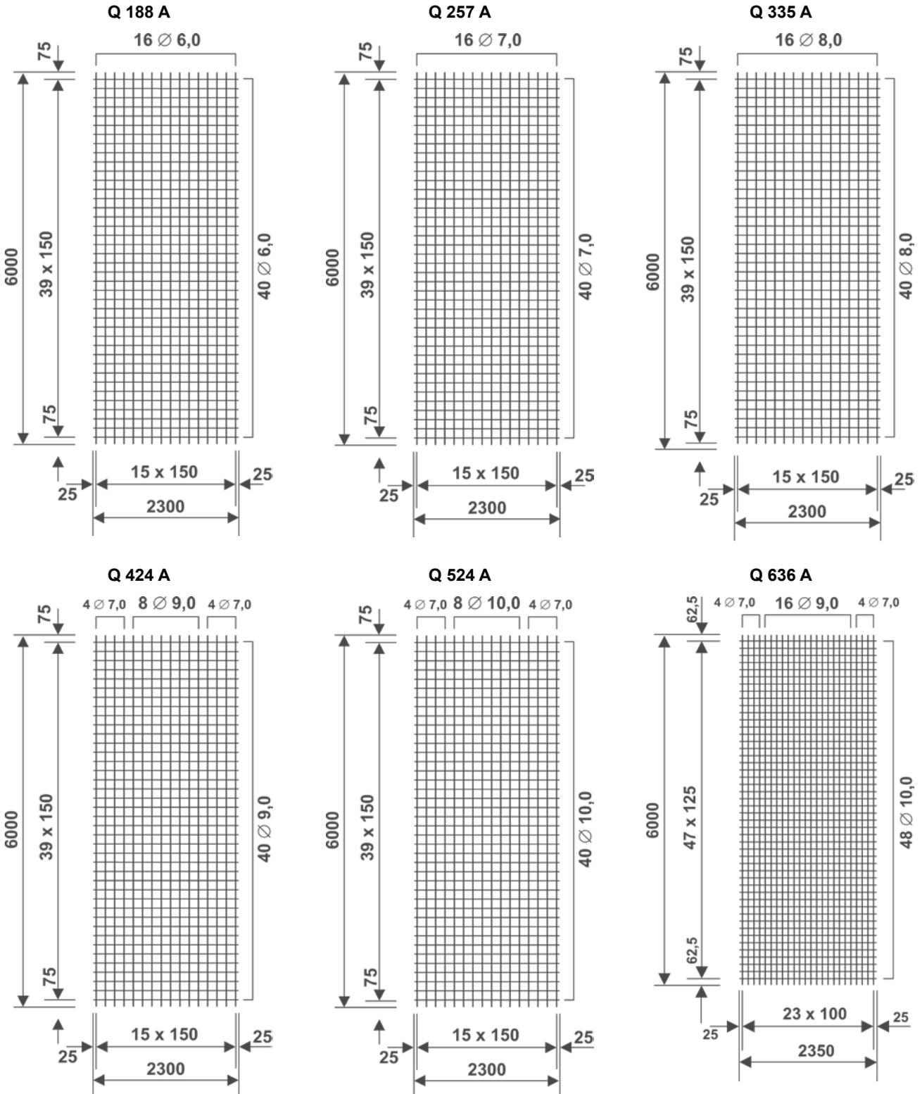
Lagermatten sind standardisierte normalduktile Betonstahlmatten mit festgelegten Abmessungen und festgelegtem Aufbau.
